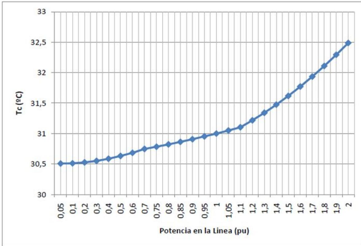
Figura 3: Cálculo térmico del conductor
