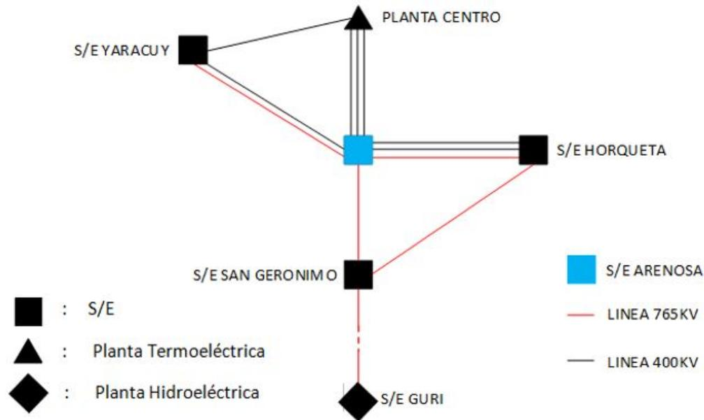
Figura 1: Sistema de anillo S/E Arenosa-S/E Horqueta-S/E Yaracuy [1]
